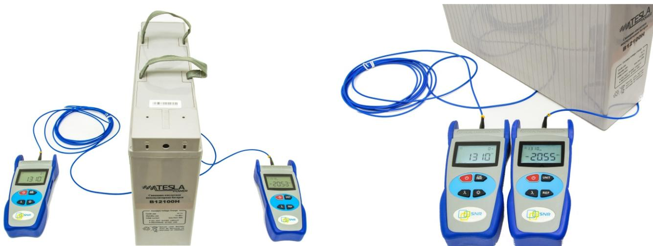
Ставим аккумулятор на армированный патчкорд, при этом значение на измерителе незначительно увеличивается и колеблется в диапазоне  $-20.45 \sim -20.55$  дБм. Соотносим эти данные с показаниями без нагрузки ( $-20.20 \sim -20.40$  дБм): вносимое затухание составило  $0.25 \sim 0.15$  дБм.
