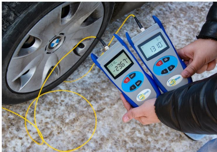
Внешняя оболочка в обеих конструкциях выполнена из LSZH компаунда. Стоит отметить, что повреждений и разрывов оболочка патчкордов в ходе испытаний не получила. Остались только следы механических воздействий.
