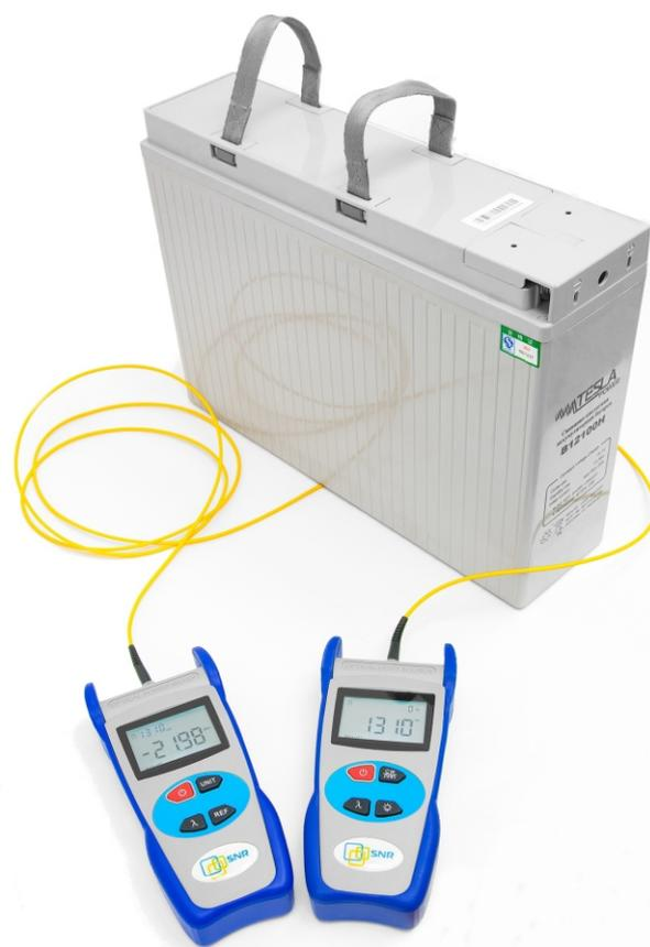
Значение на измерителе изменяется в меньшую сторону и колеблется в диапазоне:  $-21.90 \sim -22.00$  дБм. Сопоставляем с изначальными показаниями (без нагрузки):  $-20.50 \sim -20.70$  дБм. Внесенное затухание составляет  $1.40 \sim 1.30$  дБм, это значительные потери для работоспособности оптической линии.
